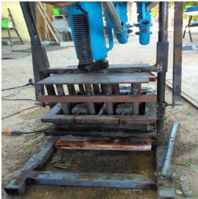
Anexo 7. Realizando muestras en la máquina bloquera.
