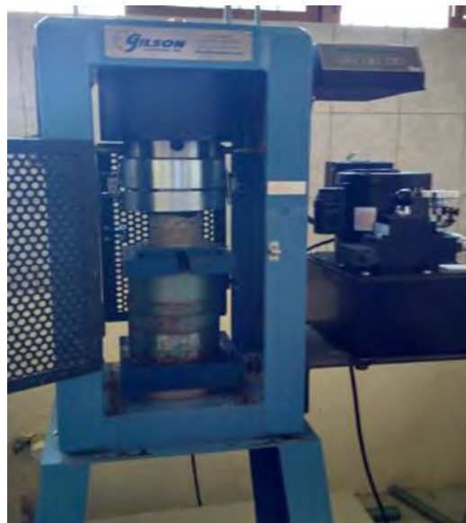
Figura 26. Ejerciendo presión en una muestra con la prensa del Laboratorio de Ing. Civil del Instituto Tecnológico Superior de Puerto Peñasco (ITSP).
