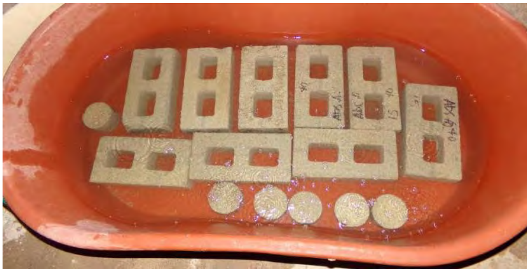
Figura 31. Realización de la prueba de absorción de agua total en 24 horas de bloques huecos y cilindros.
