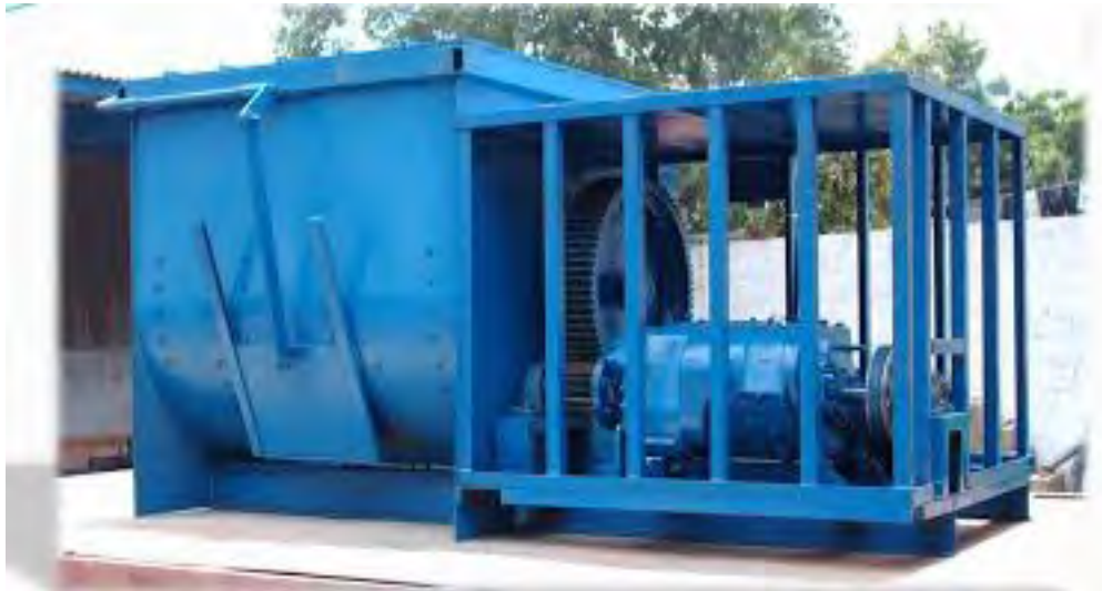
Figura 16. Mezcladora de eje horizontal utilizado en la producción de bloques, concretos, etc. Fuente: Industrias Molser, (2013)
