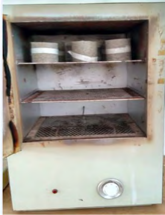
Anexo 8. Muestras cilíndricas en el horno de la universidad
