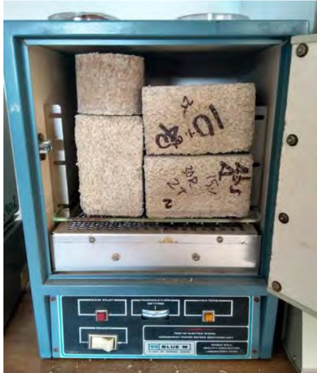
Anexo 6. Muestras colocadas en el horno para secarse.
