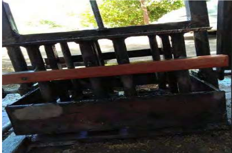
Anexo 2. Bloquera con molde para las muestras de la prueba de conductividad térmica.
