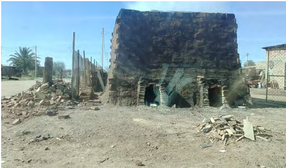
Figura 14. Horno de túnel para la cocción de ladrillos.
