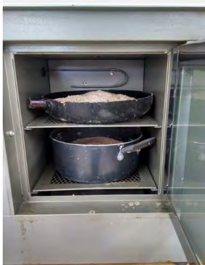
Anexo 4. Muestras de tierra y arena colocadas en un horno para secarse.
