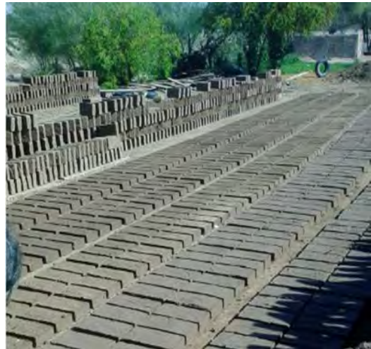
Figura 11. Ladrillos secándose en la intemperie antes de cocerse
