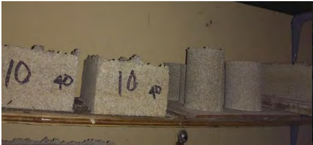
Anexo 3. Ladrillos huecos y cilindros en la cámara de fraguado.
