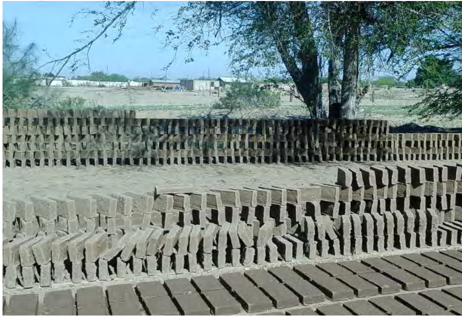
Figura 13. Mampuestos apilados esperando para ser cocidos
