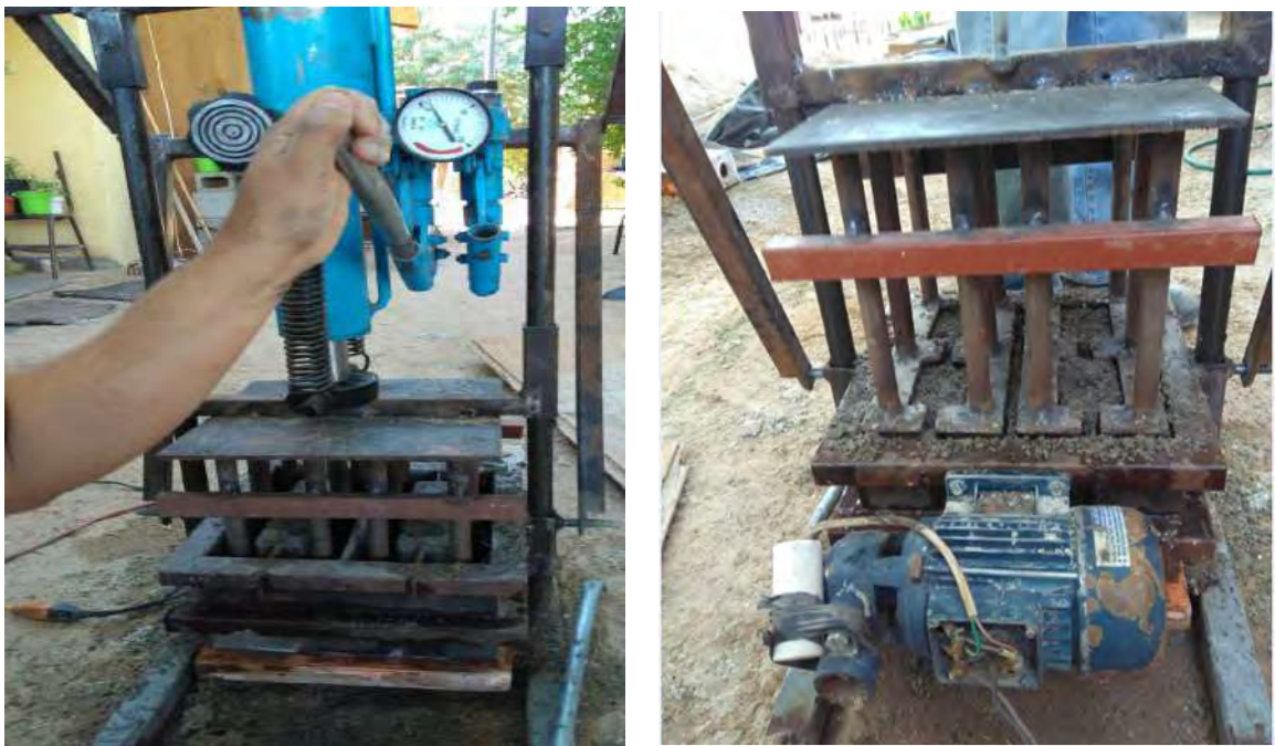
Figura 24. Elaboración de los bloques con la bloquera y la prensa
