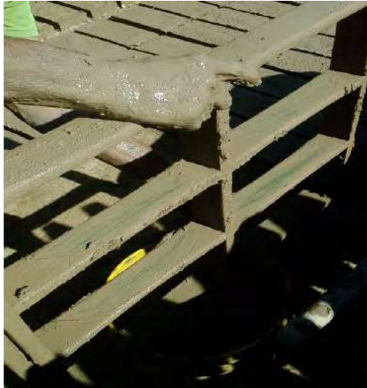
Figura 10. Rejilla sin fondo de madera utilizada en el moldeo de los ladrillos solidos
